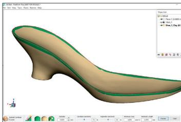
Designprozesse mit Kurven sind jetzt schneller und effizienter dank neuer Tools wie „Extract Contour Curve“, „Offset Curve“ und dem erweiterten Befehl „Pattern Axis Marker“. Mit den neuen Arbeitsabläufen können Oberflächen schneller erstellt und Muster präziser entworfen werden.
