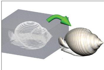
Vereinfachen von Arbeitsabläufen durch den Import von Volumendaten aus Bildstapeln direkt in Freeform Plus, wo die Daten in Voxel und Polygone konvertiert werden. Mit der neuen MultiVox-Funktion können jetzt Daten sowohl von medizinischen als auch von industriellen CT-Geräten in einer einzigen Anwendung importiert, verarbeitet und für Designs verwendet werden.\*
