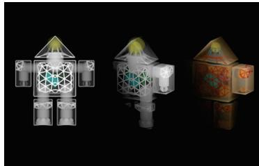
Verbesserte Genauigkeit und weniger Designiterationen durch Überprüfung der Innenstruktur mit der neuen MultiVox-Ansicht, die die Modelltransparenz nach Schichten steuert und eine abschnittsübergreifende Analyse ermöglicht. Bevor Modelle zum 3D-Druck übermittelt werden, können Designer die inneren Abstände überprüfen und einfache Messungen durchführen, um die Passform beim Zusammenbau zu gewährleisten.
