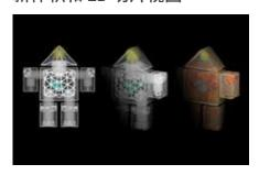
全新的 MultiVox 视图可控制每层的模型透明度并提供横截面分析,通过借助此功能来验证内部几何形状,提高精度并减少设计迭代。在将模型发送进行 3D 打印前,设计师可以检查内部间隙并进行简单的测量,来确保适合装配。
