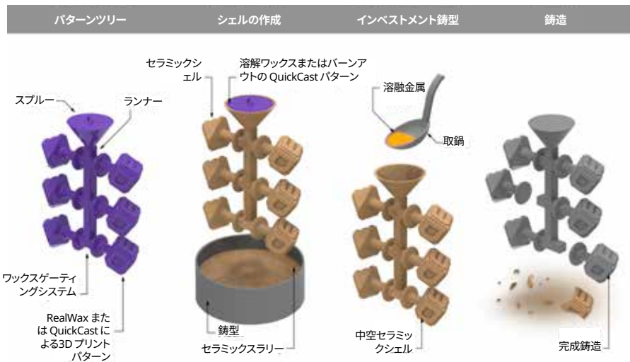
3D プリントされたパターンがロストワックスまたはシェルインベストメント鋳造プロセス用にバーンアウトされる
