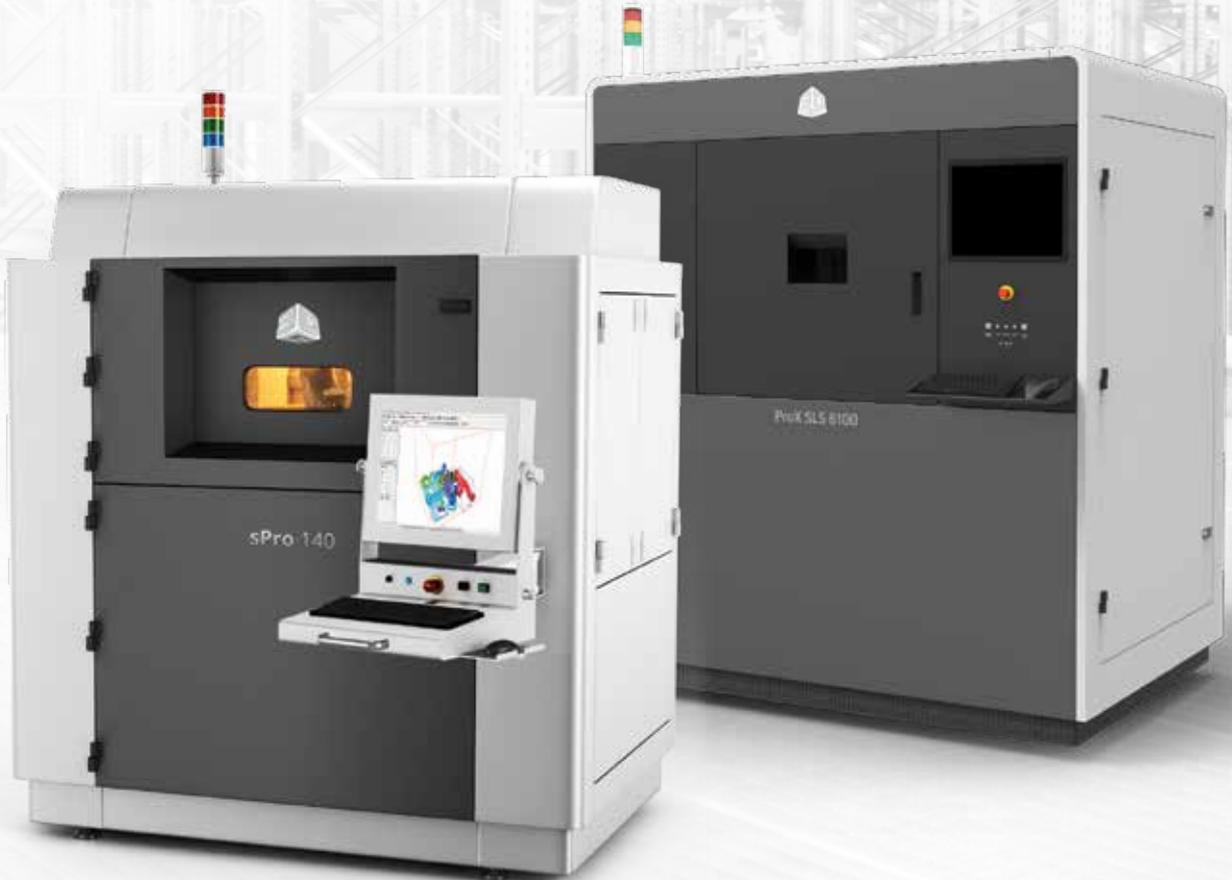
3D Systems의 선택적 레이저 소결(SLS) 3D 프린터는 표면 마감 처리, 해상도, 정확도, 재현성이 뛰어난 복잡한 기능성 경질 부품을 낮은 총 소유 비용으로 생산합니다.
