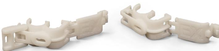
별도로 표시된 것을 제외하고, 상기 데이터에 사용된 부품은 ProX® SLS 6100 프린터에서 기본 파라미터와 80% 버진 파우더를 이용한 빌딩 부품으로 생성되었습니다.
