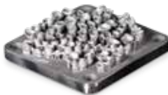
Fertigung von Teilkronen, Kronenkappen und Brücken aus LaserForm CoCr (C)
