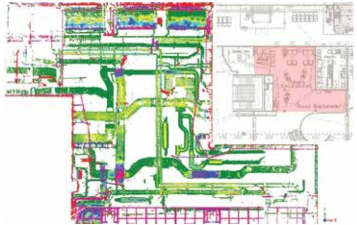
**Abbildung 2:** Die Deckenanalyse zeigt auf, wo die Daten des CAD-Modells von den tatsächlichen Begebenheiten vor Ort abweichen. Mit diesem Wissen können rechtzeitig Korrekturen angegangen werden. Bild © MEYER WERFT
