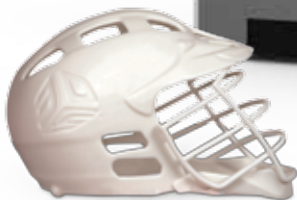
Accura Xtreme White 200 でプリントされたヘルメットモデル
